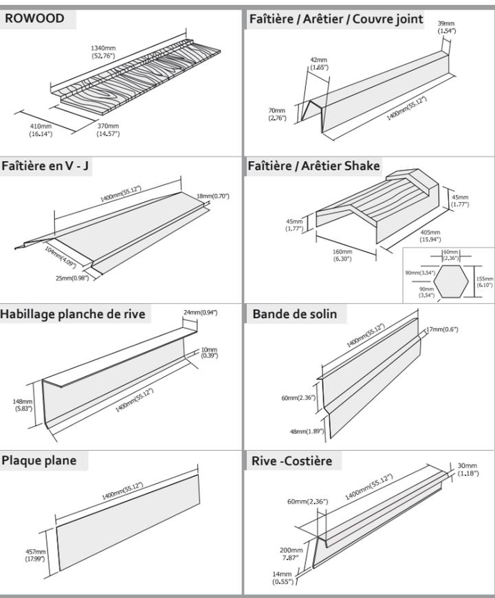
\* D'autres accessoires peuvent être utilisés avec ce profil de tuile en respectant les règles de l'art.
