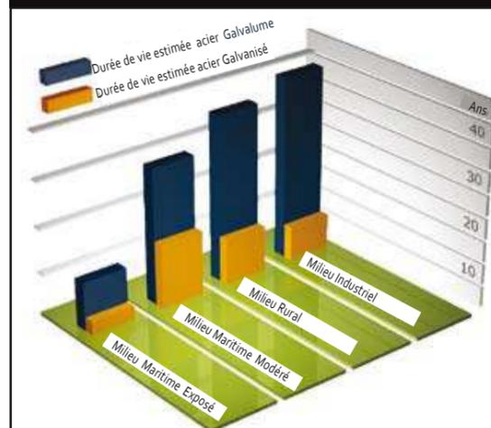
Programme de tests atmosphériques du \*Galvalume® avec des échantillons en notant la première année d'apparition de la rouille perforante.
