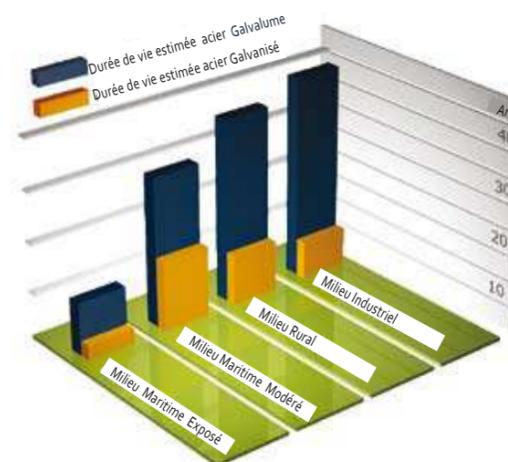
Programme de tests atmosphériques du \* Galvalume® avec des échantillons en notant la première année d'apparition de la rouille perforante.
